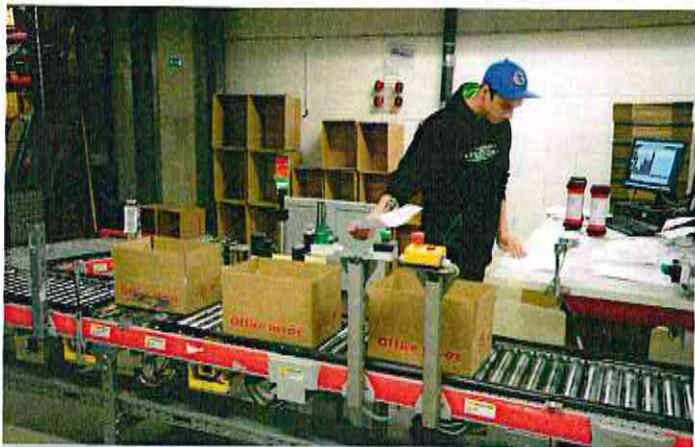
Skladník skenuje čárové kódy na balicích listech, systém podle uložených rozměrů a váhy položek navrhe velikost krabice. Na tu se automaticky natisne etiketa a dovnitř se vloží balicí list.
