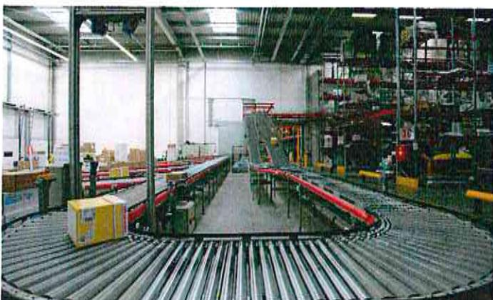
Na konci se k dopravníku z galerie připoji ještě jedna linka vedoucí z výškového skladu s méně obrátkovým drobnějším zbožím a zásilky se na závěr roztrídí do jednotlivých rámů.
